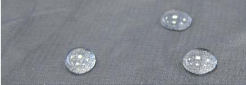
ФИГУРА 1. Найлонова тъкан, обработена с водонепропускливо, лесно за почистване покритие, базирано на течно стъкло.
